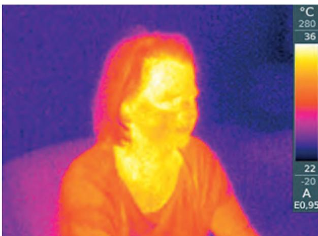
Abb. 2: Ein Passiv-Infrarot-Sensor (PIR) registriert sich schnell verändernde Wärmebilder in seinem Erfassungsbereich. Wie diese Infrarot-Aufnahme eines menschlichen Oberkörpers sichtbar macht, zeigt sich meist ein deutlicher Kontrast zwischen der Wärmestrahlung eines Menschen und seiner Umgebung.
